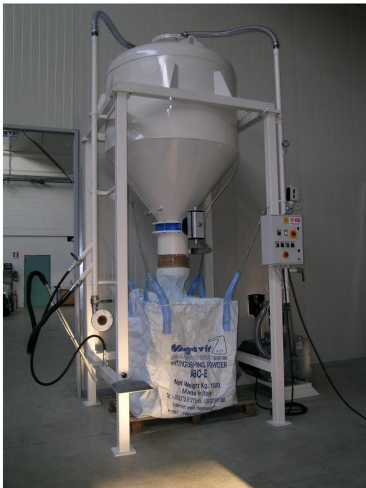
**Figura 9: Apparecchiatura svuotapolveri da estintori SILO MV**
