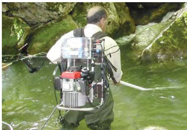
Elettrostorditore spallabile utilizzato per il campionamento ittico in piccoli corsi d'acqua
