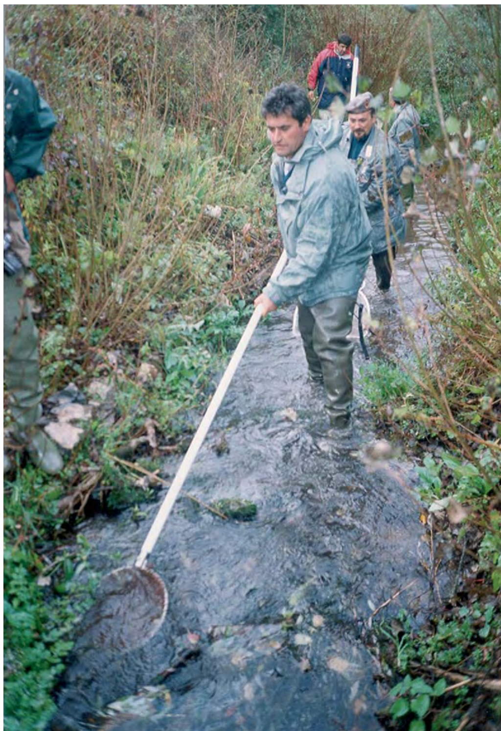
Campionamento ittico mediante elettropesca.
