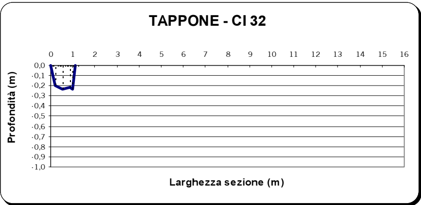
Figura 208. Sezione di misura della portata nella stazione CI 32.
