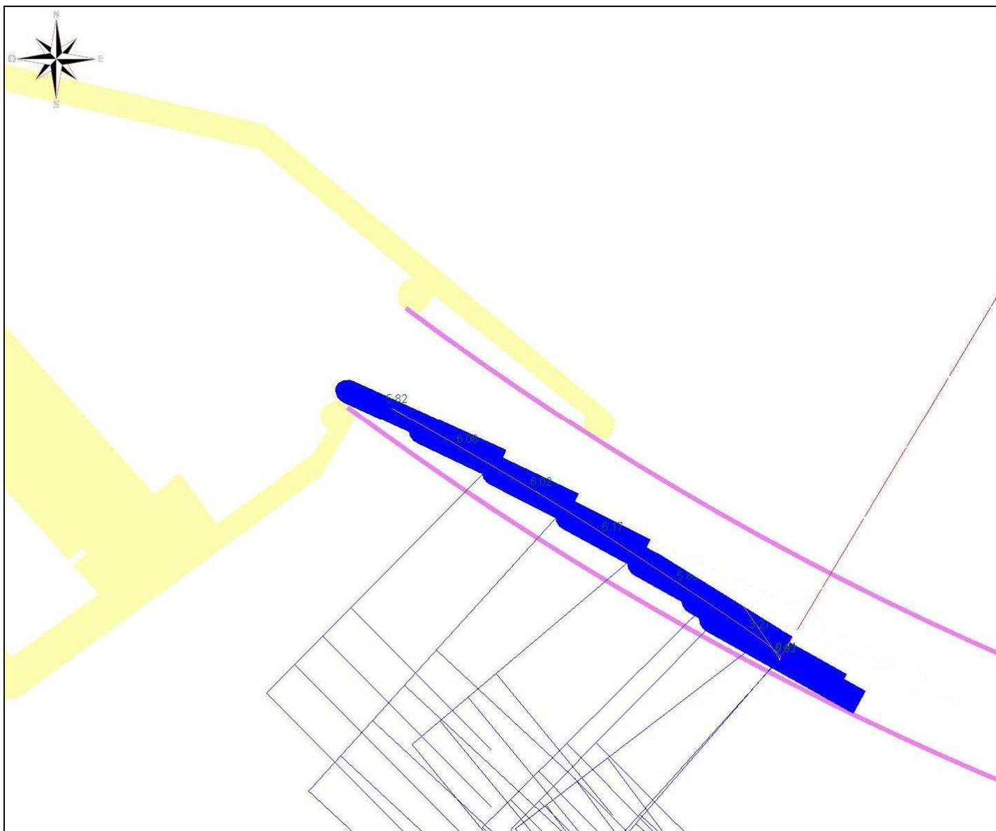
**Fig. 6C – M05, ingresso con vento da SW di 35 kn (silhouette nave ogni 30 s)**
