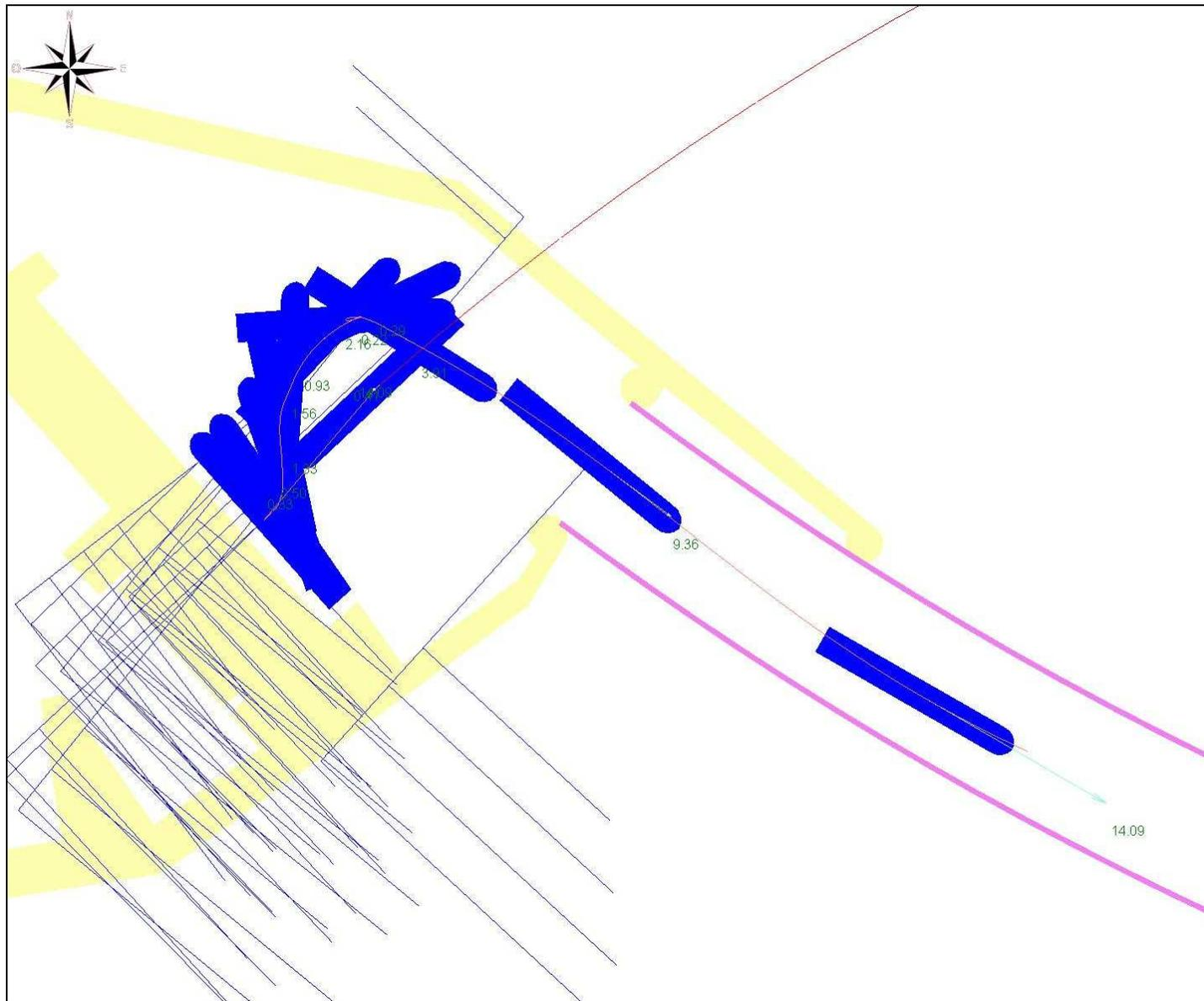
**Fig. 5C – M04, uscita con vento da SW di 35 kn (silhouette nave ogni 60 s)**
