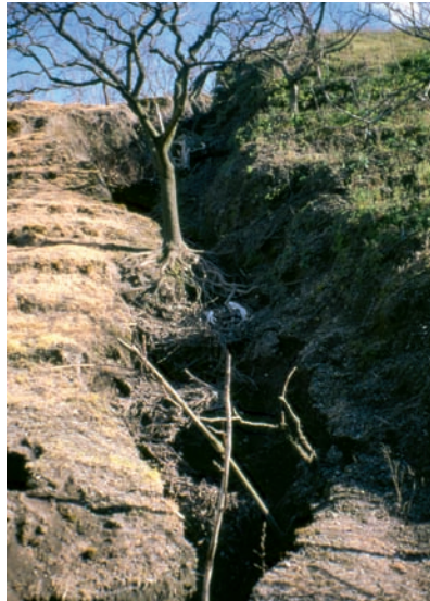
Foto 3.1: Le radici delle piante legano le particelle di suolo e lo rinforzano, aumentando la resistenza al taglio (Parco Nazionale del Vesuvio) - Foto P. Cornellini
