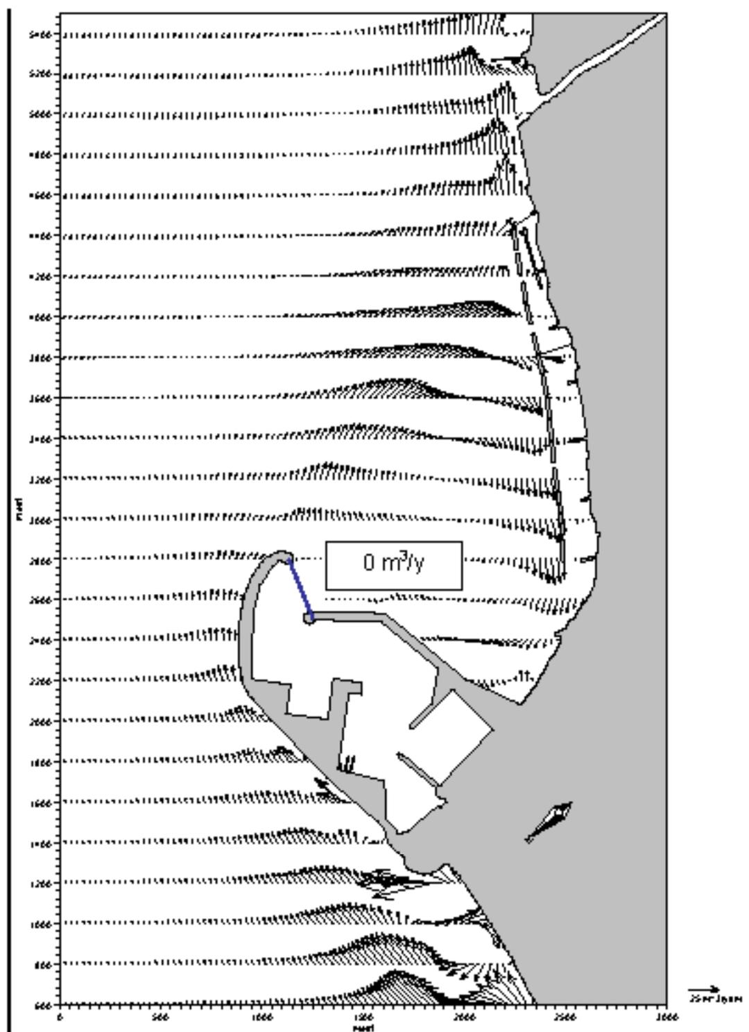
**Fig. 7.6** Campo della capacità di trasporto solido con il clima medio annuo nella configurazione di progetto
