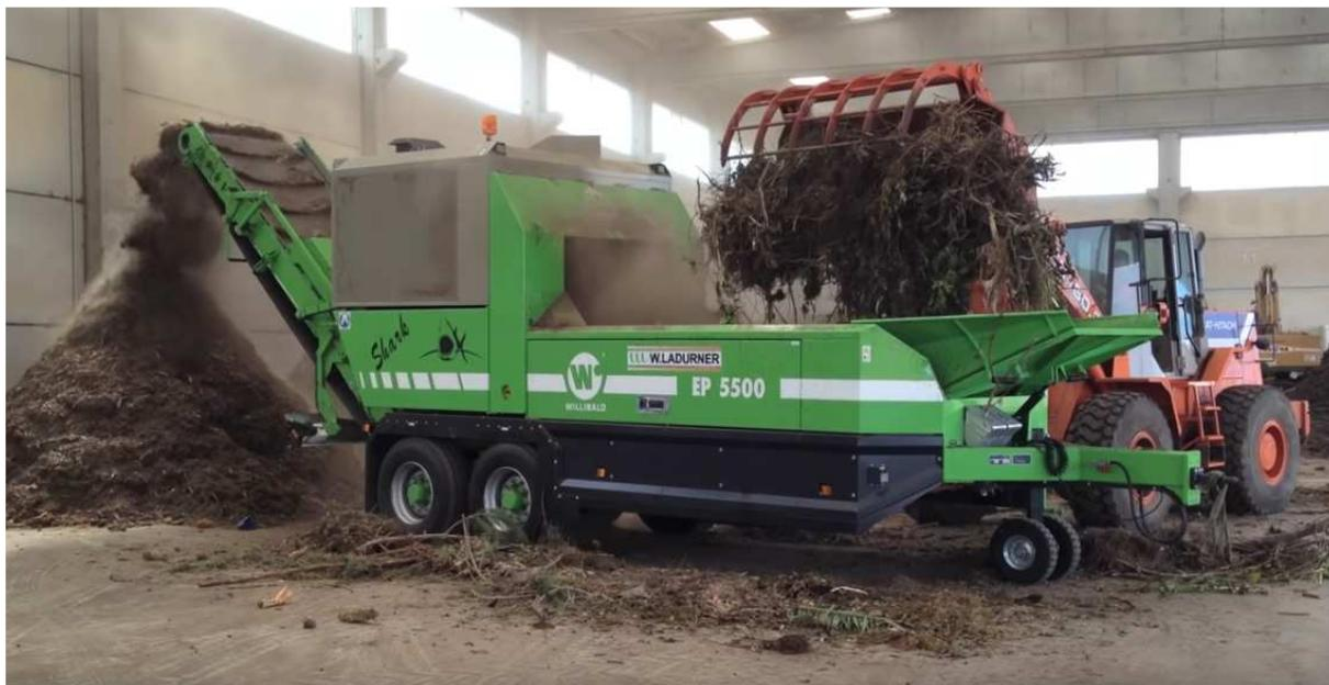
Figura 18 Esempio di tritratore per strutturante durante l'alimentazione con pala gommata [TheWladurner, Willibald]
