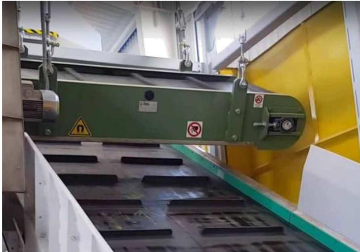
Figura 13: Esempio di deferrizzatore elettromagnetico - ALTEN WASTE ENGINEERING SRL.
