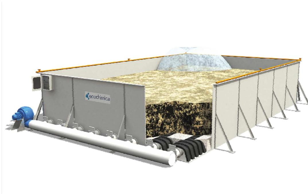
Figura 28: Spaccato assonometrico di un biofiltro [Ecochimica]
