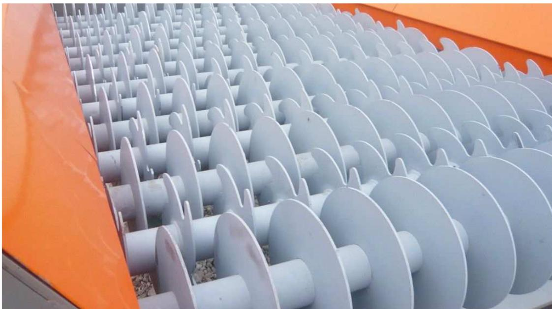
Figura 14: Esempio di Vaglio a dischi – ARJES
