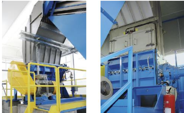
FIGURA 26: MACINAZIONE AD ACQUA DEI CONTENITORI IN PET - ESEMPIO APPLICATIVO.
