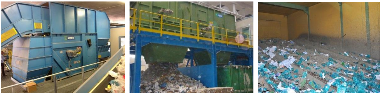
FIGURA 14: SEPARATORE BALISTICO A 8 PALE - ESEMPIO APPLICATIVO.
