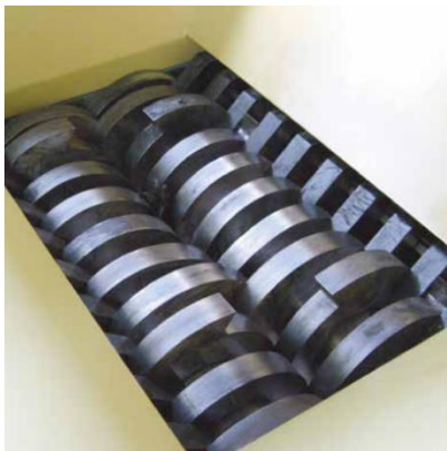
FIGURA 10: PARTICOLARE DI UN TRITURATORE ESEMPIO APPLICATIVO
