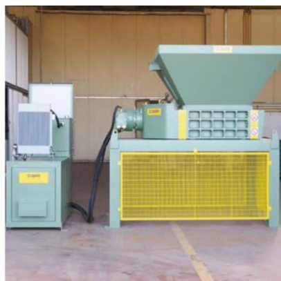
FIGURA 65: PARTICOLARE DI UN TRITURATORE A DOPPIO ALBERO
