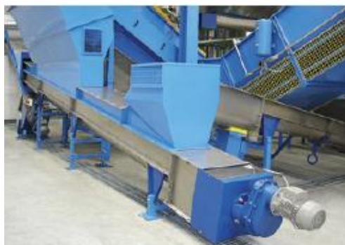
FIGURA 92: SISTEMA CENTRALIZZATO DI RACCOLTA DEGLI SCARTI - ESEMPIO IMPIANTO REALIZZATO
