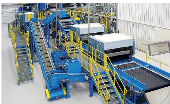
FIGURA 80: A SINISTRA SELETTORE OTTICO NIR, A DESTRA ESEMPIO PIATTAFORMA DI SELEZIONE MANUALE
