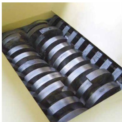
FIGURA 65: PARTICOLARE DI UN TRITURATORE A DOPPIO ALBERO
