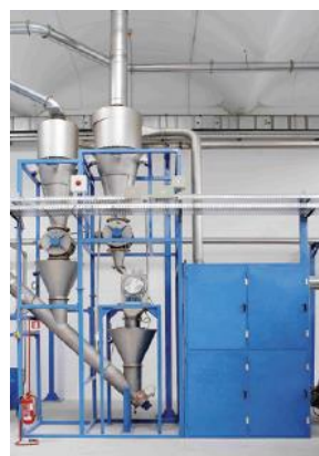
FIGURA 85: A SINISTRA LA CENTRIFUGA MECCANICA, A DESTRA L'ESSICCATORE - ESEMPIO IMPIANTO REALIZZATO
