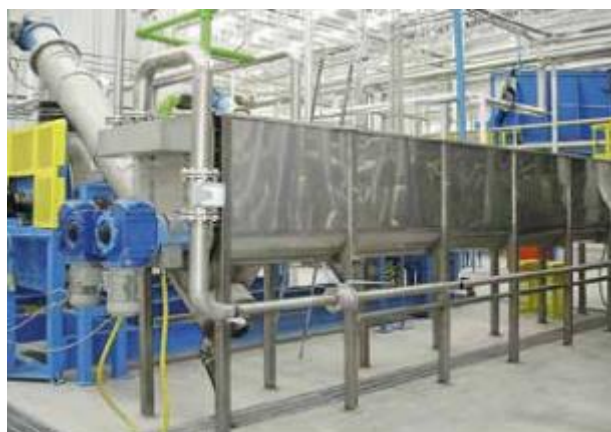
FIGURA 82: VASCA DI PRE-FLOTTAZIONE - ESEMPIO IMPIANTO REALIZZATO.
