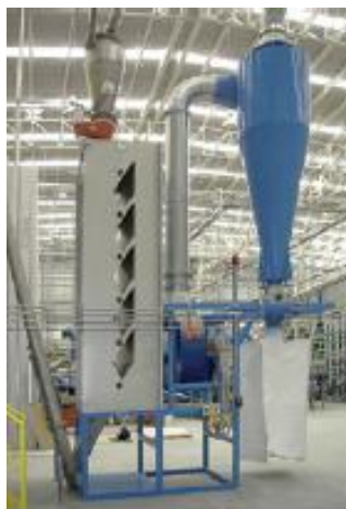
FIGURA 88: DEPOLVERATORE - ESEMPIO IMPIANTO REALIZZATO.
