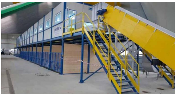
FIGURA 68: VISTE DELLA CABINA DI CERNITA MANUALE : ESEMPI REALIZZATIVI
