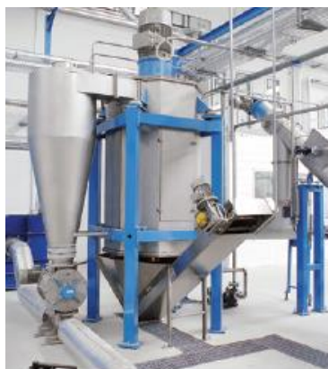
FIGURA 85: A SINISTRA LA CENTRIFUGA MECCANICA, A DESTRA L'ESSICCATORE - ESEMPIO IMPIANTO REALIZZATO
