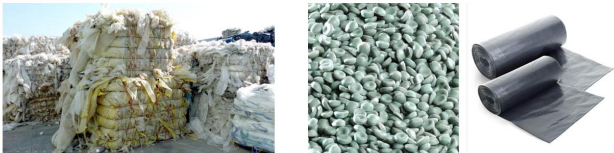
FIGURA 11: PROCESSO DI RICICLO DEL FILM DA IMBALLAGGIO PER OTTENERE NUOVO FILM DA IMBALLAGGIO O PELLETS A PARTIRE DA SCAGLIE DI R-FILM
