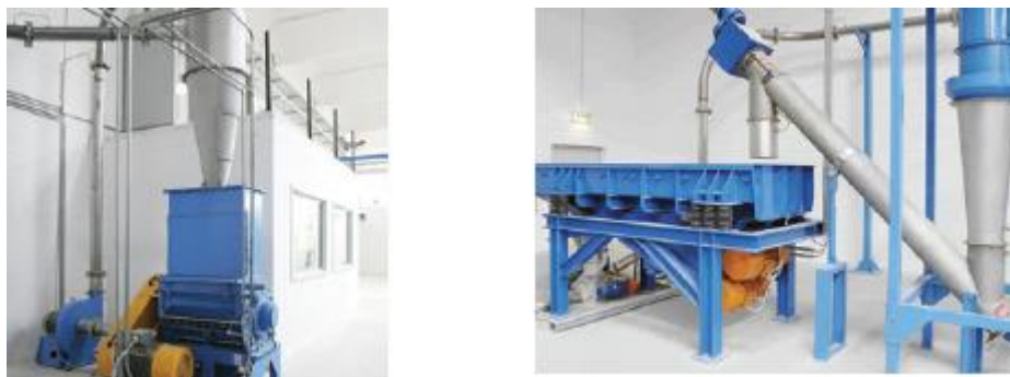
FIGURA 86: A SINISTRA IL MULINO A LAME PER LA MACINAZIONE FINALE, A DESTRA IL VAGLIO VIBRANTE - ESEMPIO IMPIANTO REALIZZATO
