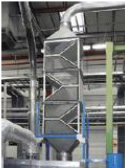
FIGURA 93: SEPARATORE TAPPI/ETICHETTE - ESEMPIO IMPIANTO REALIZZATO
