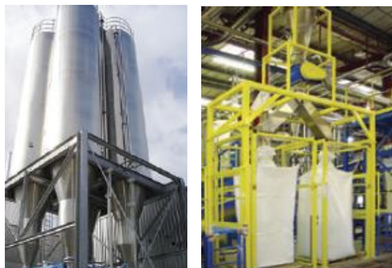
FIGURA 90: SILOS DI ACCUMULO DELLE SCAGLIE A SINISTRA, STAZIONE DI RIEMPIMENTO DELLE BIG-BAGS A DESTRA - ESEMPIO IMPIANTO REALIZZATO
