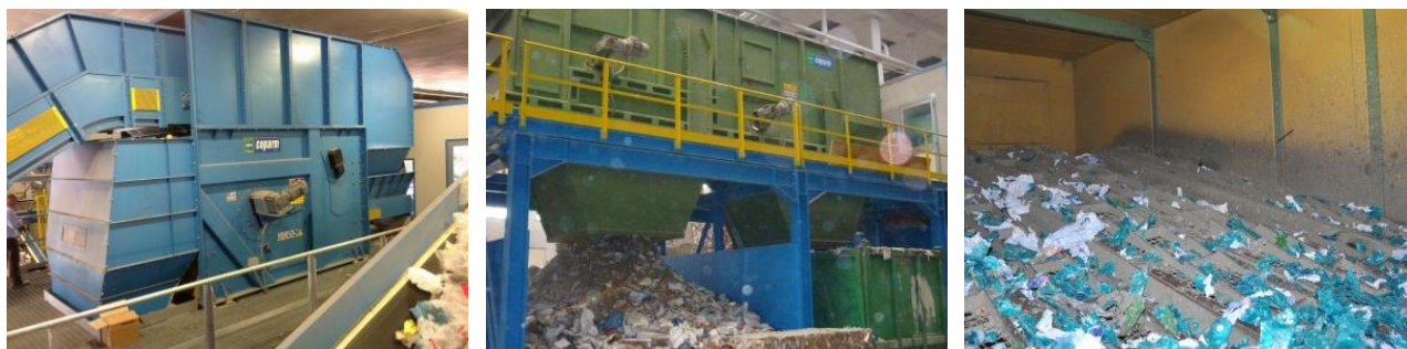
FIGURA 69: ESEMPIO SEPARATORE BALISTICO A 8 PALE
