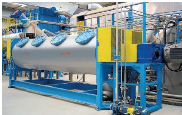
FIGURA 83: LAVAGGIO A CALDO AD ALTA FRIZIONE (FRICTION WASHER) - ESEMPIO IMPIANTO REALIZZATO
