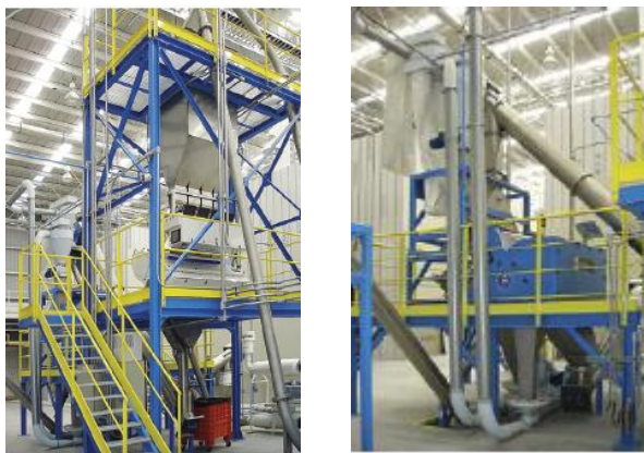
FIGURA 89: A SINISTRA IL SELETTORE PER COLORE, A DESTRA IL DEFERRIZZATORE - ESEMPIO IMPIANTO REALIZZATO
