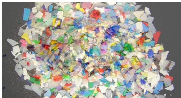
FIGURA 7: SCAGLIE DI HDPE OTTENUTE IN USCITA DALL'IMPIANTO DI LAVAGGIO E MACINAZIONE
