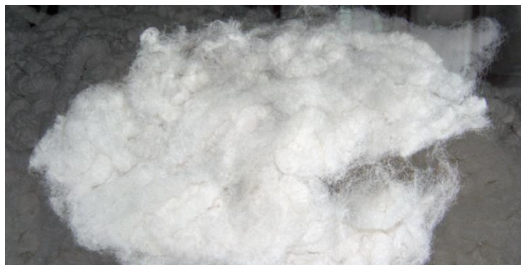
FIGURA 5: FIBRE TESSILI PRODOTTE A PARTIRE DA SCAGLIE IN R-PET
