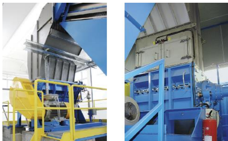
FIGURA 81: MACINAZIONE AD ACQUA DEI CONTENITORI IN PET – ESEMPIO IMPIANTO REALIZZATO
