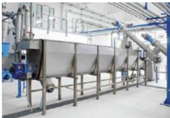
FIGURA 84: VASCA DI RISCIAQUO A CALDO E FREDDO - ESEMPIO IMPIANTO REALIZZATO
