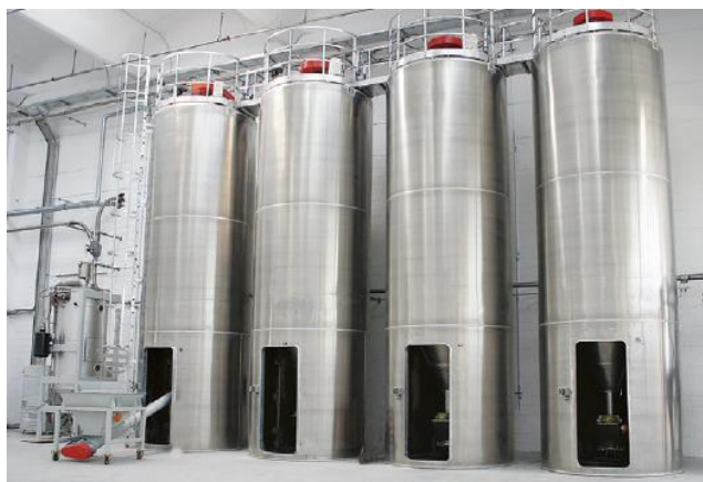
FIGURA 87: SILOS MISCELATORI - ESEMPIO IMPIANTO REALIZZATO
