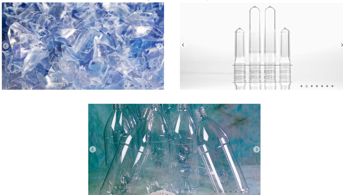
FIGURA 2: ESEMPIO DI SEQUENZA DI PRODUZIONE DI SCAGLIE IN R-PET, FORME E BOTTIGLIE IN R-PET E PET VERGINE
