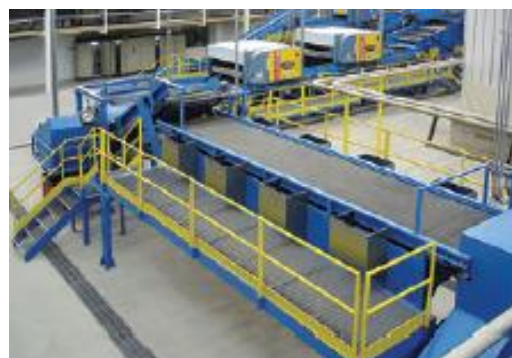
FIGURA 80: A SINISTRA SELETTORE OTTICO NIR, A DESTRA ESEMPIO PIATTAFORMA DI SELEZIONE MANUALE
