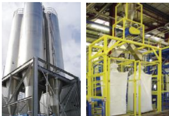
FIGURA 35: SILOS DI ACCUMULO DELLE SCAGLIE A SINISTRA, STAZIONE DI RIEMPIMENTO DELLE BIG-BAGS A DESTRA - ESEMPIO APPLICATIVO.
