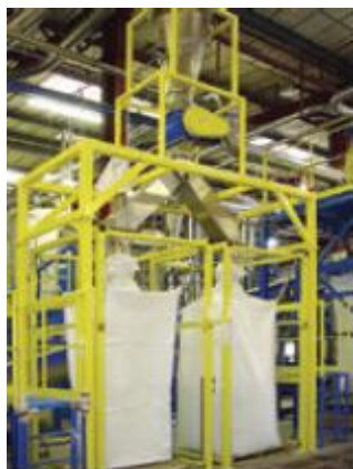
FIGURA 44: STAZIONE DI RIEMPIMENTO DELLE BIG-BAGS A DESTRA - ESEMPIO APPLICATIVO.
