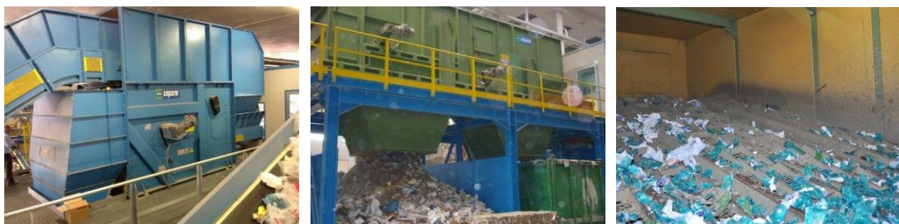
FIGURA 14: SEPARATORE BALISTICO A 8 PALE - ESEMPIO APPLICATIVO.
