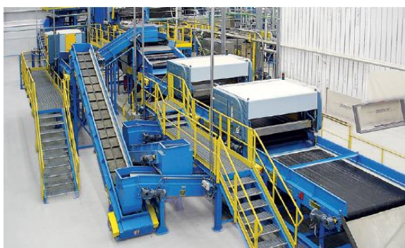
FIGURA 25: A SINISTRA SELETTORE OTTICO NIR, A DESTRA PIATTAFORMA DI SELEZIONE MANUALE - ESEMPIO APPLICATIVO.
