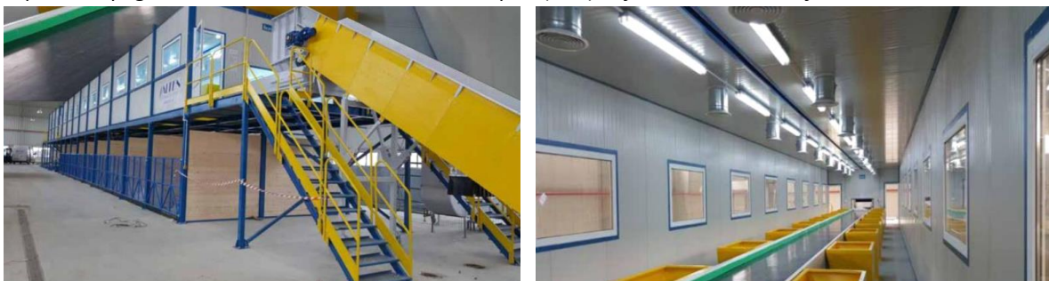
FIGURA 13: VISTE DELLA CABINA DI CERNITA MANUALE (ALTEN WASTE ENGINEERING SRL).
