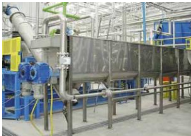
FIGURA 27: VASCA DI PRE-FLOTTAZIONE - ESEMPIO APPLICATIVO.
