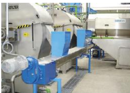
FIGURA 36: SISTEMA DI FILTRAZIONE MECCANICA DELLE ACQUE DI LAVAGGIO - ESEMPIO APPLICATIVO.
