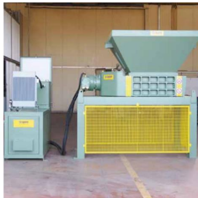
FIGURA 10: PARTICOLARE DI UN TRITURATORE ESEMPIO APPLICATIVO
