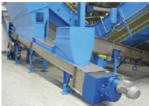
FIGURA 37: SISTEMA CENTRALIZZATO DI RACCOLTA DEGLI SCARTI - ESEMPIO APPLICATIVO.
