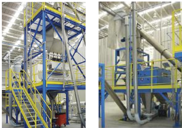
FIGURA 34: A SINISTRA IL SELETTORE PER COLORE, A DESTRA IL DEFERRIZZATORE - ESEMPIO APPLICATIVO.
