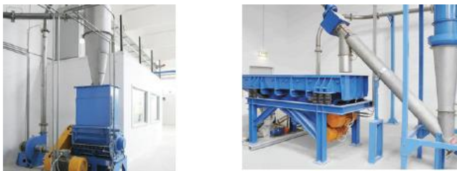
FIGURA 31: A SINISTRA IL MULINO A LAME PER LA MACINAZIONE FINALE, A DESTRA IL VAGLIO VIBRANTE - ESEMPIO APPLICATIVO.
