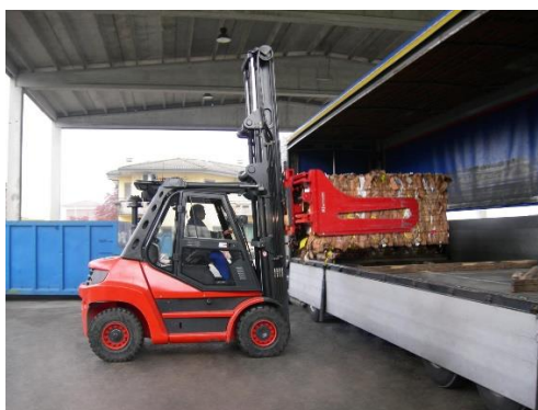
FIGURA 41: MULETTO PER LA MOVIMENTAZIONE DELLE BALLE DI MATERIALE PLASTICO (IMMAGINE DAL WEB).
