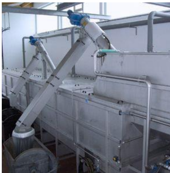
FIGURA 51: VIBROVAGLIO CON COMPATTATORE A COCLEA – HUBER TECHNOLOGY SRL.
