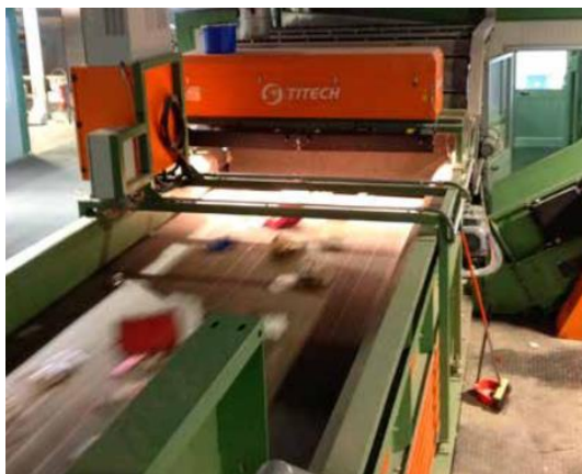
FIGURA 16: SELETTORE OTTICO BINARIO NIR 2000 – ESEMPIO APPLICATIVO
