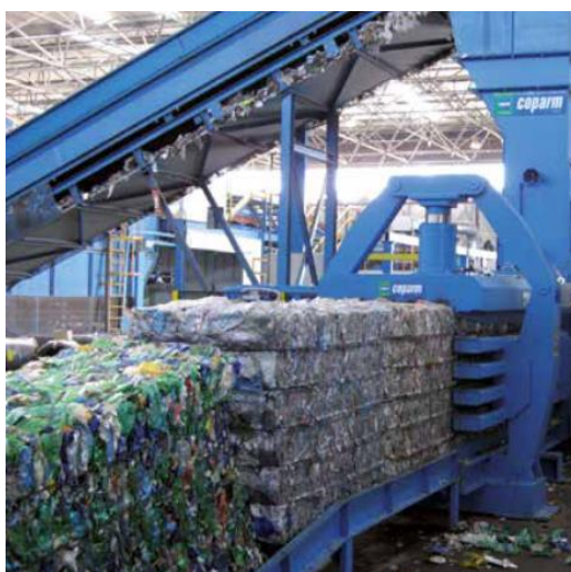
FIGURA 21: PRESSA PER L'IMBALLAGGIO DEL PET – ESEMPIO APPLICATIVO.
