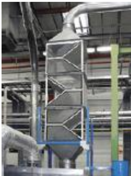
FIGURA 38: SEPARATORE TAPPI/ETICHETTE - ESEMPIO APPLICATIVO.
