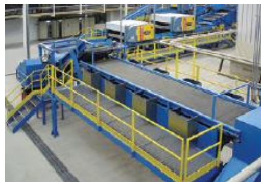
FIGURA 25: A SINISTRA SELETTORE OTTICO NIR, A DESTRA PIATTAFORMA DI SELEZIONE MANUALE - ESEMPIO APPLICATIVO.
