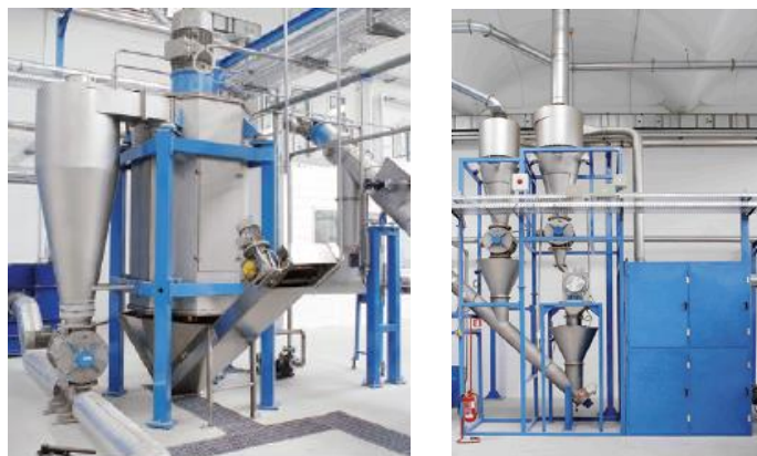
FIGURA 30: A SINISTRA LA CENTRIFUGA MECCANICA, A DESTRA L'ESSICCATORE - ESEMPIO APPLICATIVO.
