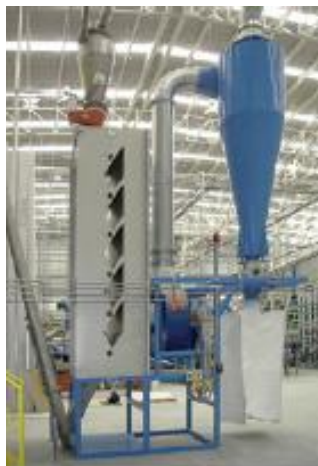
FIGURA 33: DEPOLVERATORE - ESEMPIO APPLICATIVO.
