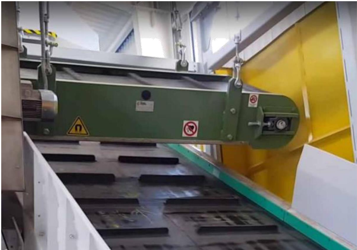
Figura 23: Esempio di deferrizzatore elettromagnetico - ALTEN WASTE ENGINEERING SRL.
