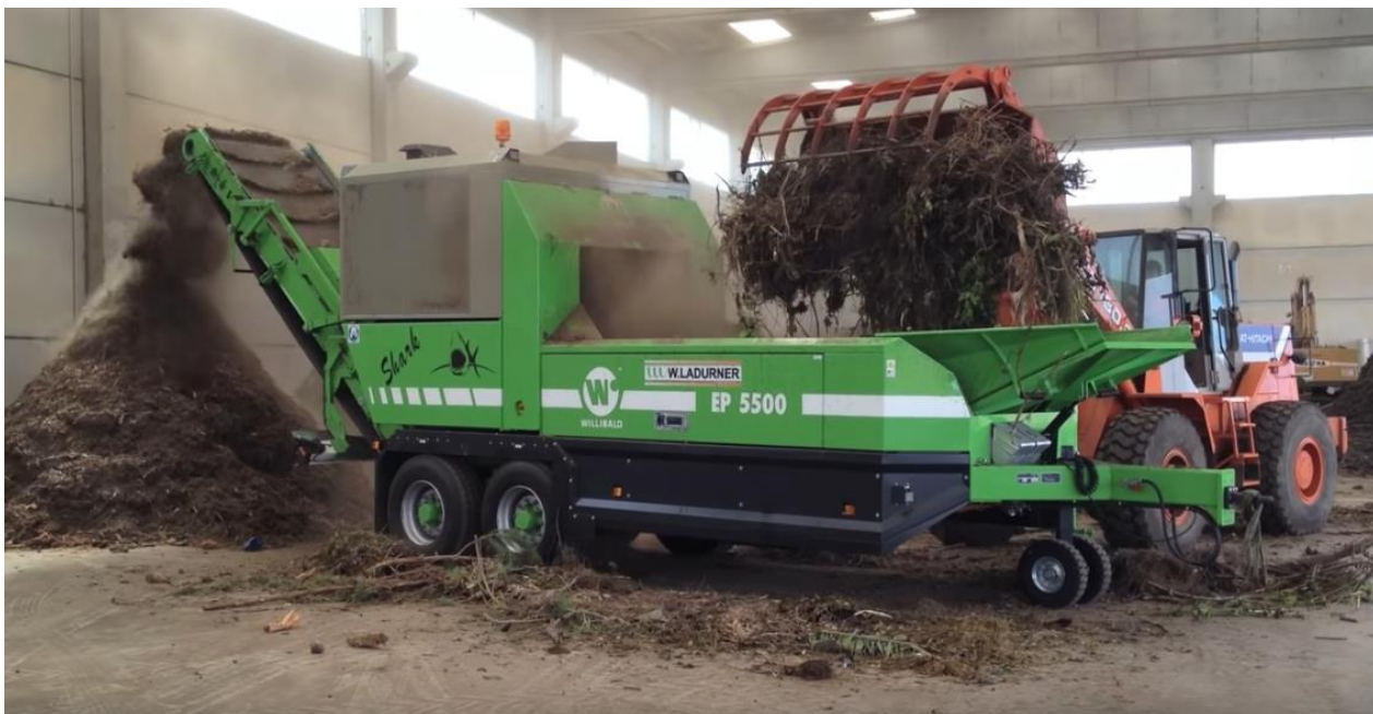
Figura 17 Esempio di trituratore per strutturante durante l'alimentazione con pala gommata [TheWLADURNER, Willibald]
