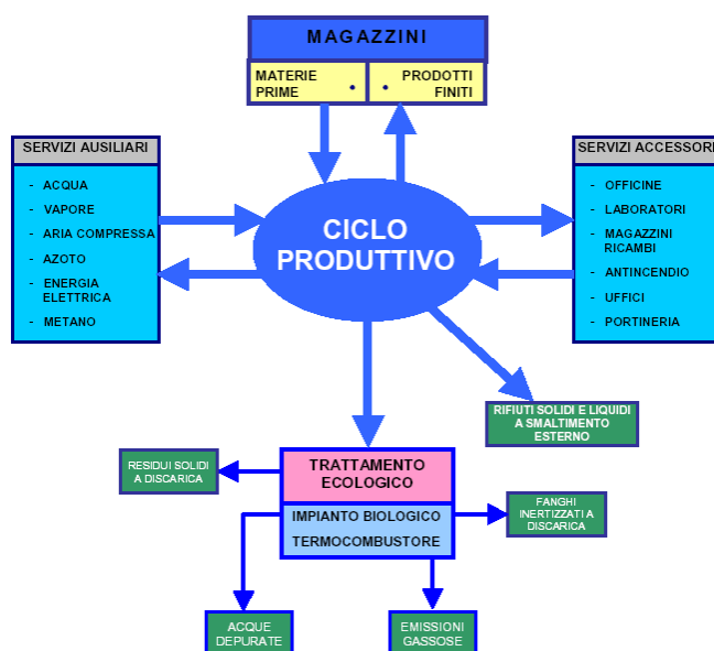
Figura 2: schema a blocchi dei servizi connessi al ciclo produttivo: assetto "ante operam"
