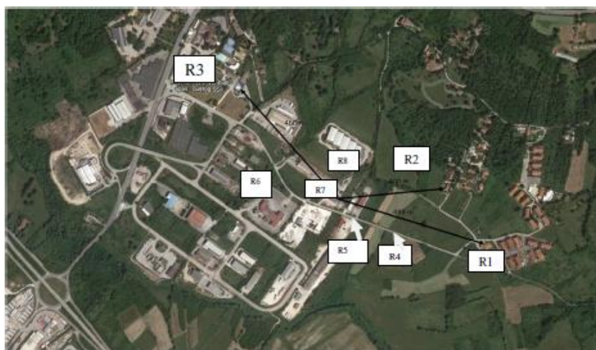
Figura 2: planimetria dell'installazione con indicazione dei punti di misura del clima acustico sul confine aziendale
