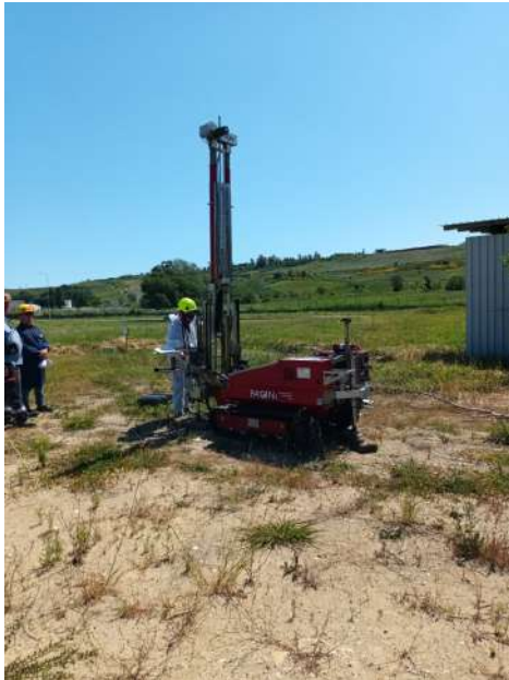
Prova penetrometrica DPSH1
