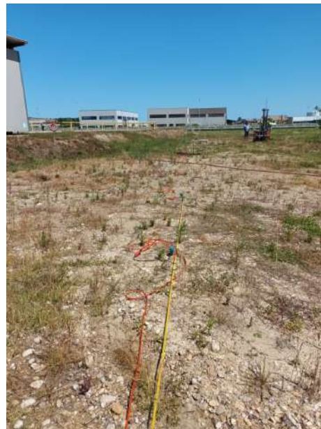
Approntamento linee sismiche SR1-M1
