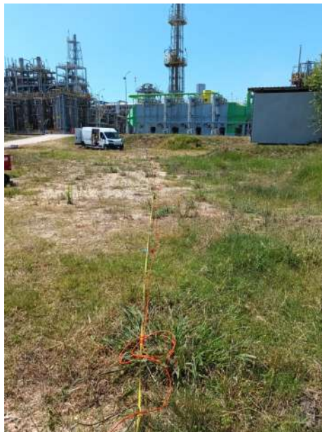
Approntamento linee sismiche SR1-M1
