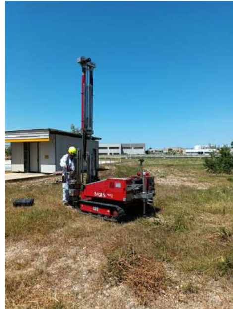
Prova penetrometrica DPSH2
