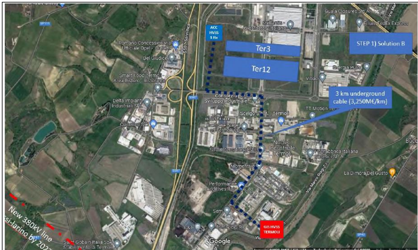
Percorso del cavidotto interrato di connessione temporanea da 380 kV con Sorgeria (Fase 1)
