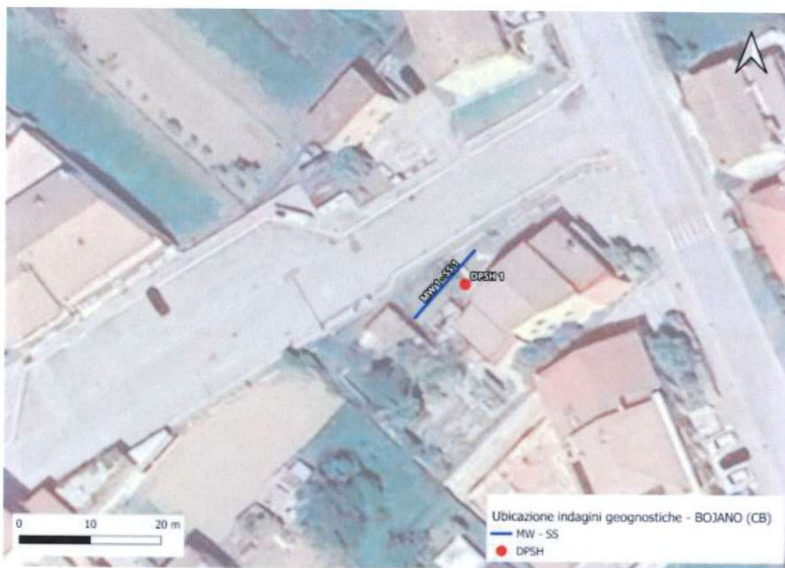
Figura 19- Ubicazione delle indagini geotecniche e geofisiche eseguite.
