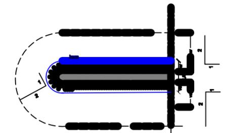
PER OGNI FASE DI REALIZZAZIONE DELLE OPERE A GETTATA DOVRANNO ESSERE UTILIZZATE LE CATEGORIE DI MASSI NATURALI INDICATE NEI DISEGNI CON LA MESSA IN OPERA DEGLI ELEMENTI LAPIDEI DI DIMENSIONI MINORI VERSO L'INTERNO DELLA SCOGLIERA. L'EVENTUALE UTILIZZO DI UNA CATEGORIA INFERIORE RISPETTO A QUELLE INDICATE È AMMESSA SOLO IN MINIMA PARTE CON LO SCOPO DI MINIMIZZARE I VUOTI ED AUMENTARE IL GRADO DI STABILITÀ DELL'OPERA.
