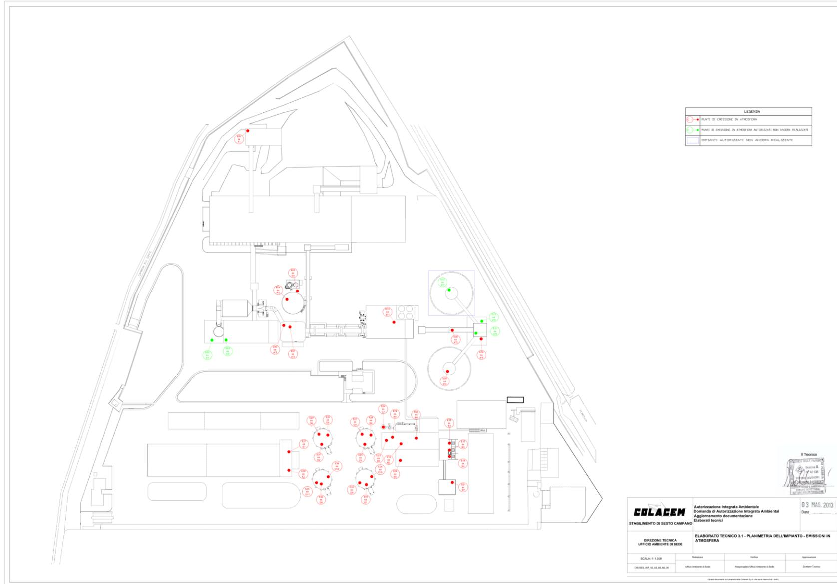
Figura 12: planimetria generale dell’installazione con indicazione dei punti di emissione in atmosfera: assetto “ante operam”
