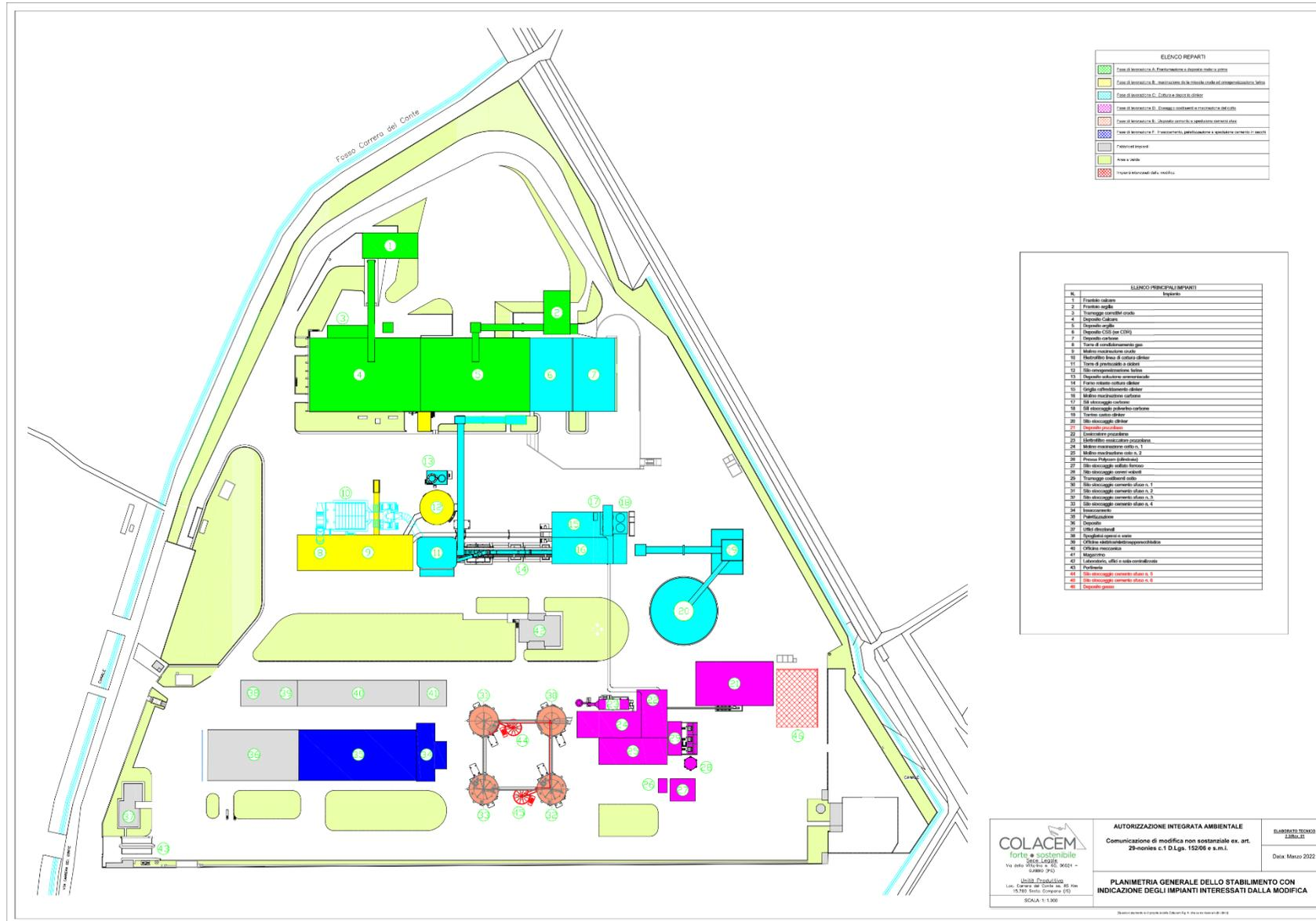
Figura 14: planimetria generale dell’installazione con indicazione degli impianti interessati dalle modifiche progettuali
