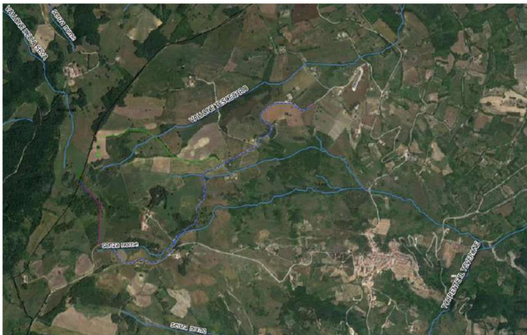
Figura 5-16. Carta del reticolo idrografico (in verde il layout originario che interferiva nel cavidotto con una linea di deflusso superficiale).
