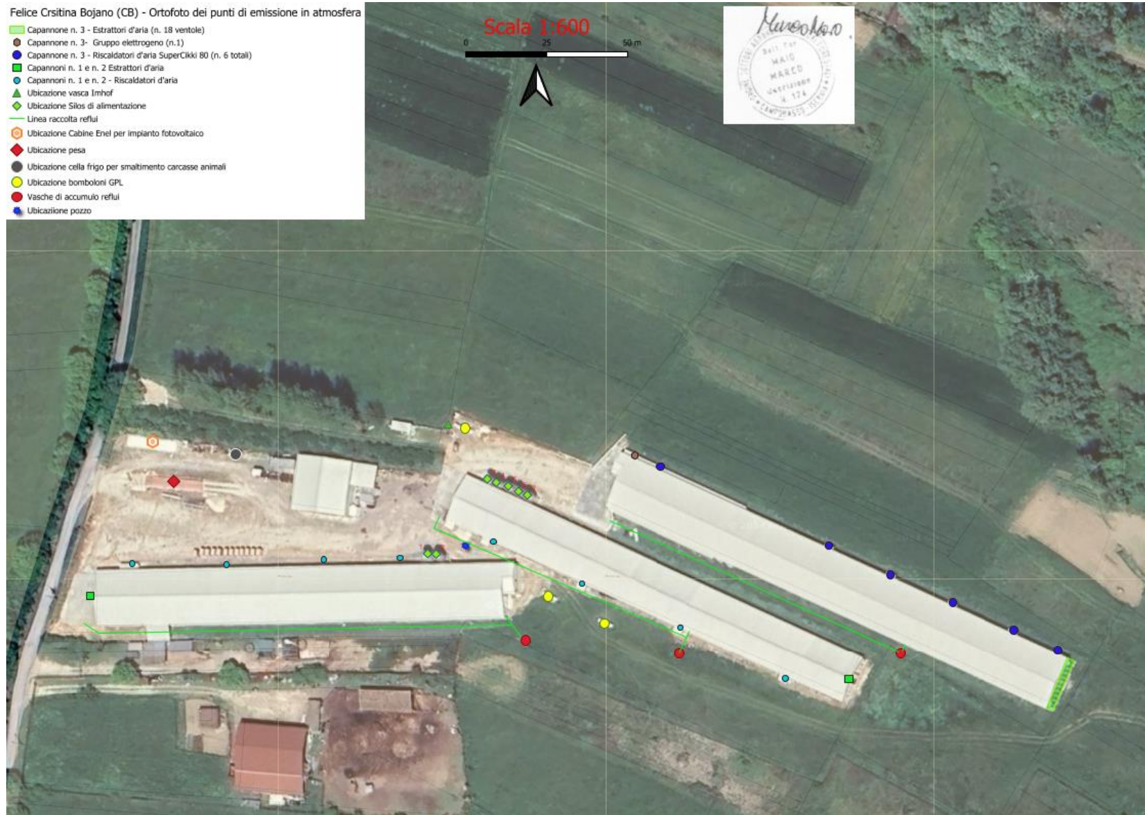
Figura 12: planimetria generale di stabilimento con indicazione dei punti di emissioni in atmosfera e dei punti di emissioni idrica
