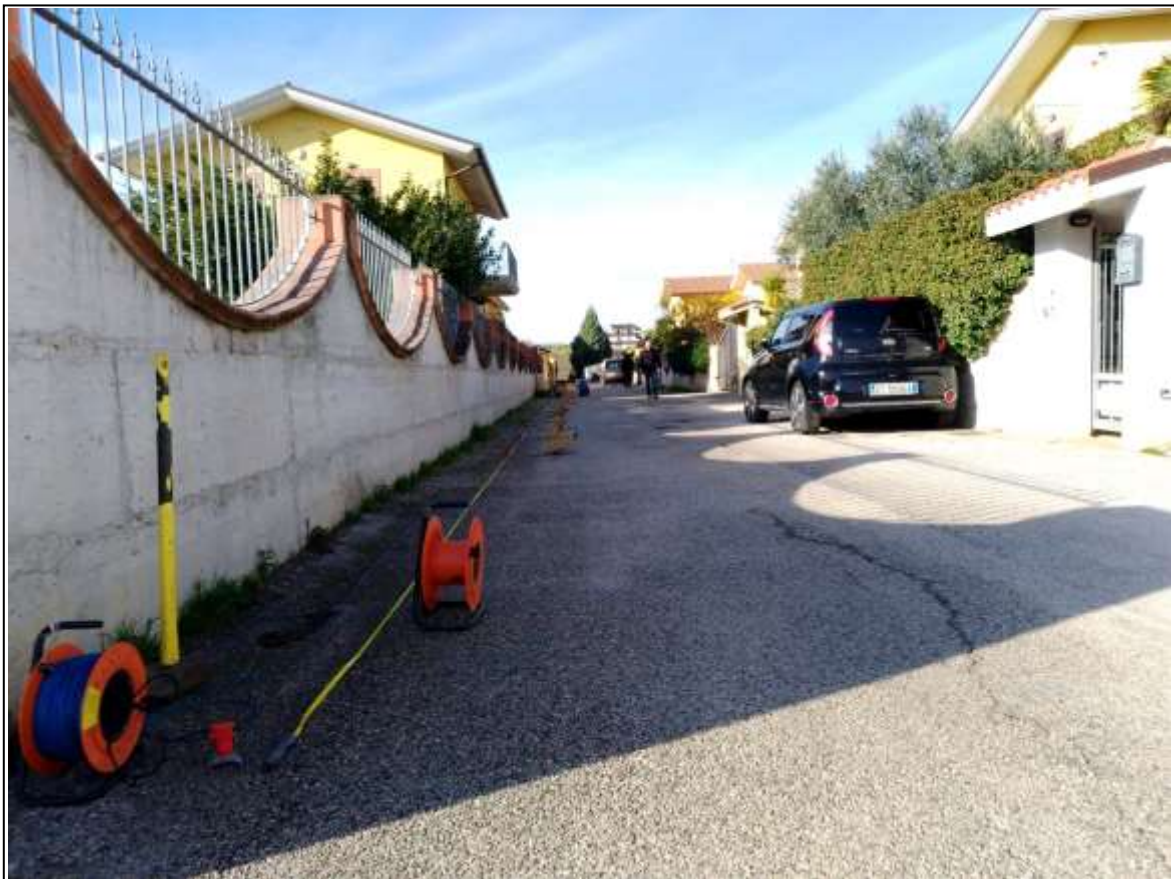
Foto 7 - Stesa sismica M.A.S.W. vista da A
