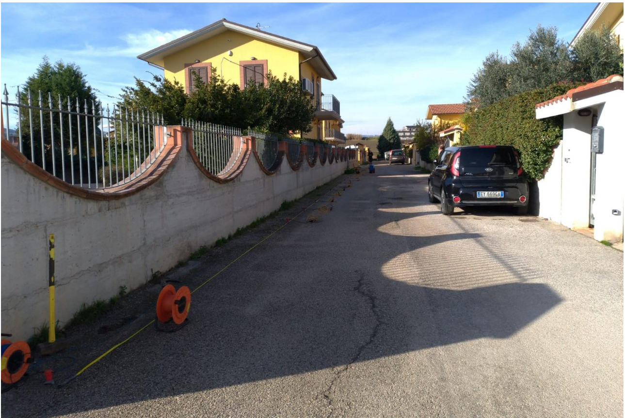
Figura 9: esecuzione profilo Masw.
